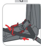
Straffen Sie den Dreipunktgurt indem Sie zunächst am Gurt in der Nähe des Dreipunktgurtschlusses (**X**) ziehen. Nun ziehen Sie den Diagonalgurt (**U**) straff nach oben in Richtung Aufrollmechanismus. Klemmen Sie den Gurt durch Schließen und Verriegeln der Gurtklemme (**GK**) fest.
