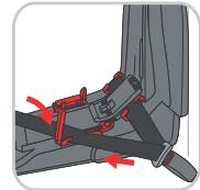
затягивания трехточечных ремней безопасности. Затяните трехточечный ремень сначала погнув за ремень рядом с замком трехточечного ремня (X). Затем тую натяните диагональный ремень (U) в направлении механизма скручивания ремня. Зафиксируйте ремень, закрыв и крепко защелкнув карабинами фиксации ремня (SK).
