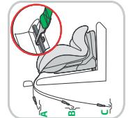
Nehmen Sie nun den Top Tether (TT) und führen ihn unter der Kopfstütze des Fahrzeugs entlang zum passenden Top Tether Verankerungspunkt des Fahrzeugs. Diesen entnehmen Sie bitte Ihrer Betriebsanleitung des Autos. Haken Sie den Top Tether ein und ziehen Sie den Gurt straff.
